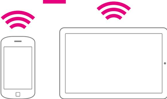
Die Internetanbindung via Funksignal nennt sich **WLAN (Wireless Local Area Network)** – ein drahtloses lokales Netzwerk. Der Router baut hierbei per Funk eine Verbindung zu den Endgeräten (PC, Laptop, TV etc.) auf.
