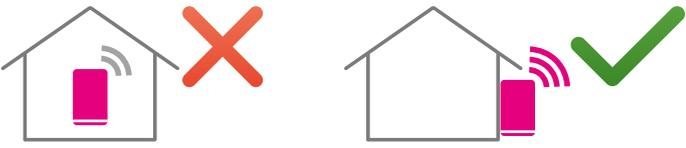
Der 5G-Empfänger muss für einen stabilen Betrieb **außen** montiert werden.
