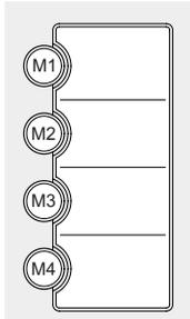
Ihr Telefon bietet Ihnen über Zielwahltasten die Möglichkeit durch einfachen Tastendruck häufig benötigte Rufnummern oder Funktionen zu wählen. Es stehen dafür vier Tasten zur Verfügung. Durch Doppelbelegung dieser Tasten haben Sie die Möglichkeit, 8 Rufnummern oder Funktionen zu vergeben.
