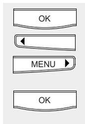
Drücken Sie die OK-Taste und anschließend die Pfeiltasten (<) oder (>), bis auf dem Display „Vermitteln“ angezeigt wird.
