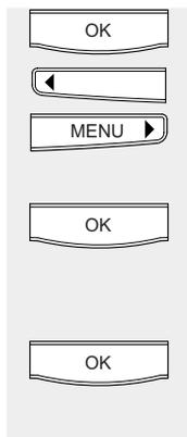
Drücken Sie die OK-Taste. Die Statusanzeige wechselt von der Anzeige von Gesprächsgebühren auf die gewählte Nummer. Wechseln Sie das Untermenü mit den Pfeiltasten, bis „Mikrofon EIN“ auf dem Display erscheint.
