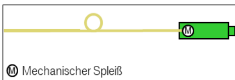
Abbildung 40: Prinzipdarstellung eines Steckers mit integriertem mechanischem Spleiß (Quelle: DT)
