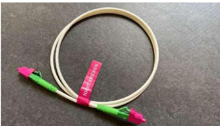
Abbildung 27: Glasfaser-Verbindungskabel mit LC-APC Steckern und magentafarbener Schutzkappe (Quelle: DT)
