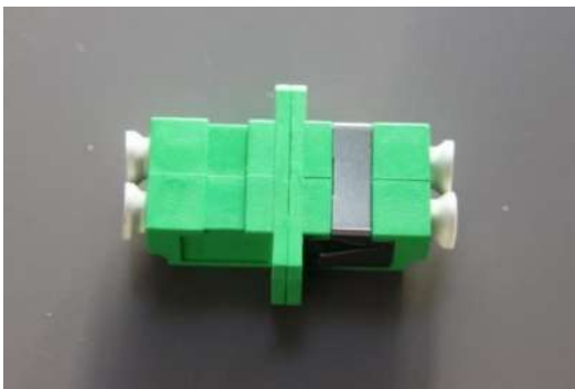
Abbildung 37: Glasfaserdurchführungskupplung (Duplex) für 2 LC-APC-Steckverbindungen (Quelle: DT)
