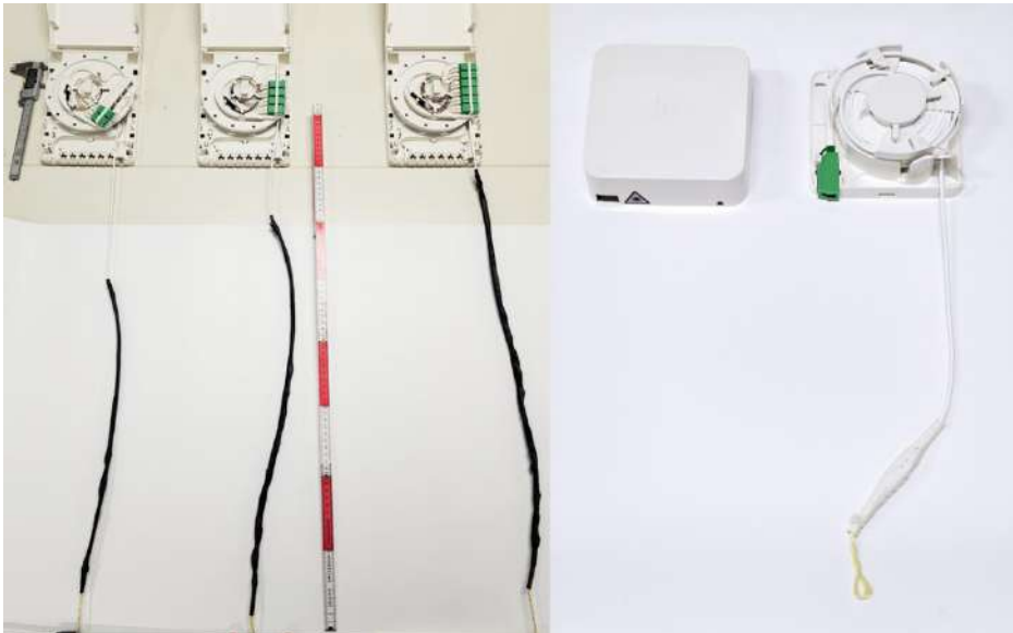
Abbildung 46: (Haupt-)Komponenten der spleißlosen Netzebene 4: Gf-EV (4, 8 und 12 Port), Gf-TA (Quelle: DT)
