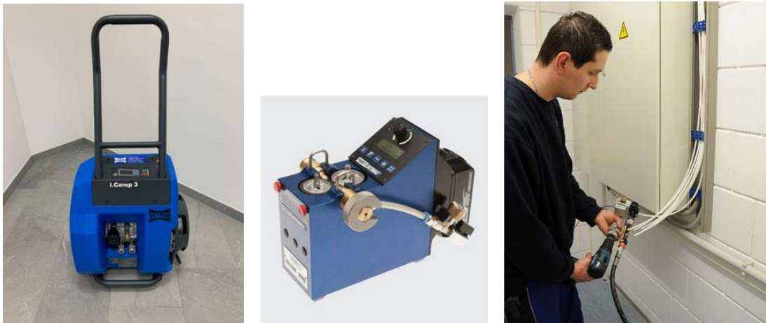
Abbildung 18: Kompressor, Einblasgerät u. Kabeleinblasvorgang in Mikrorohr der NE4 (Quelle: Fa. Vetter)
