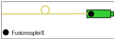
Abbildung 38: Prinzipdarstellung zur Konfektionierung eines „Spleißsteckers“ an ein Kabelende (Quelle: DT)
