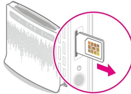
Sie verwenden bereits eine SIM-Karte in Ihrem Speedport LTE. Diese SIM-Karte benötigen Sie auch für Ihren Speedport Hybrid. Entnehmen Sie bitte die SIM-Karte durch einen leichten Druck auf die SIM-Karte.
