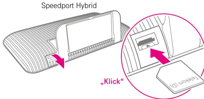
Öffnen Sie die Klappe links unten auf der Rückseite des Speedport Hybrid.
