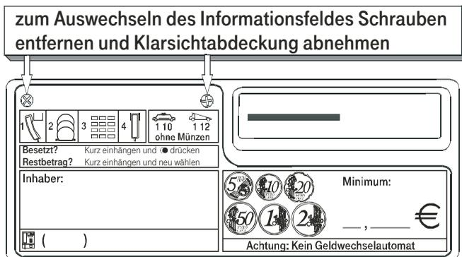
Zum leichteren Abnehmen der Klarsichtabdeckung kann eine der entfernten Schrauben etwas verkantet in ein Befestigungsloch der Klarsichtabdeckung gesteckt werden (Vorsicht: Abdeckung dabei nicht verkratzen). Mit der Schraube kann die Abdeckung heruntergeklappt werden.
