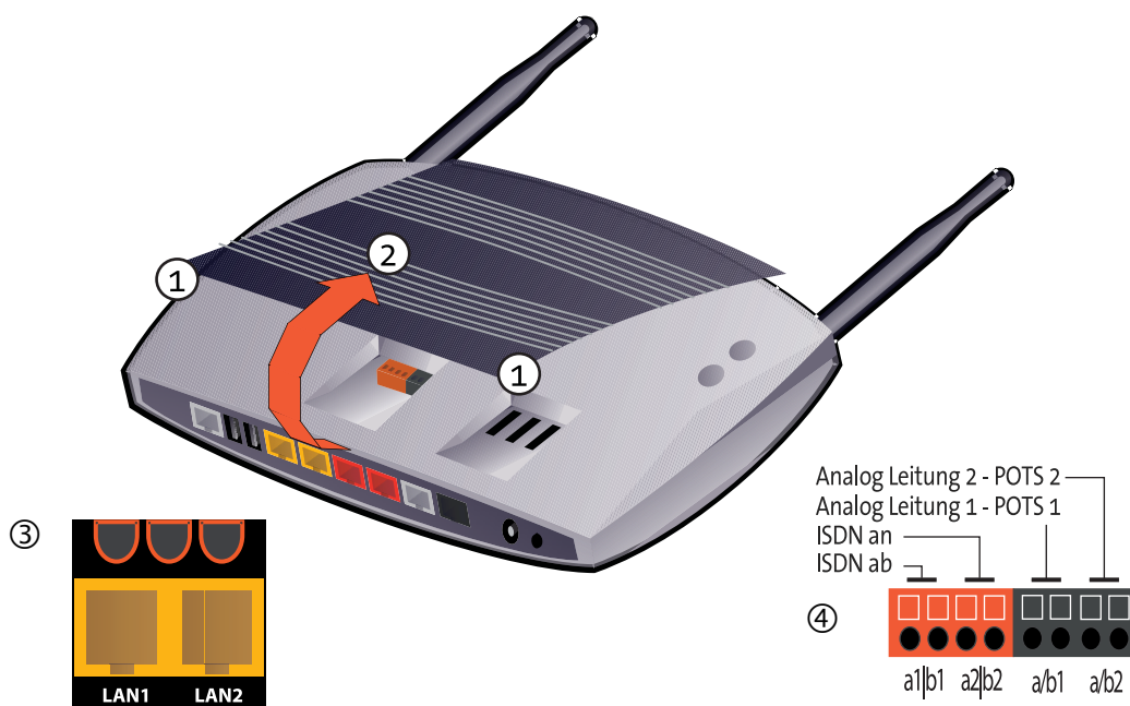
Abbildung 5 Anschlussklemmen für Direktverdrahtung
