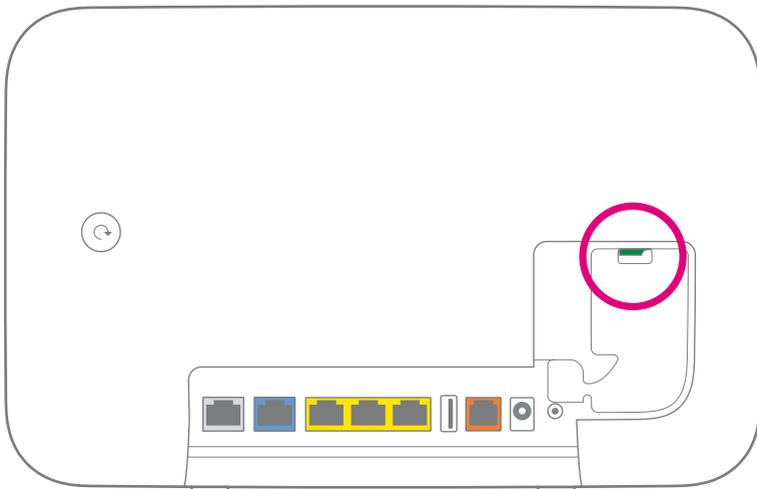
In Ihrem Speedport Smart 4 Plus ist die Funktion eines Glasfaser-Modems bereits integriert. So können Sie auf ein externes Glasfaser-Modem verzichten und Ihren Speedport direkt an die Glasfaser-Dose in Ihrem Haushalt anschließen.
