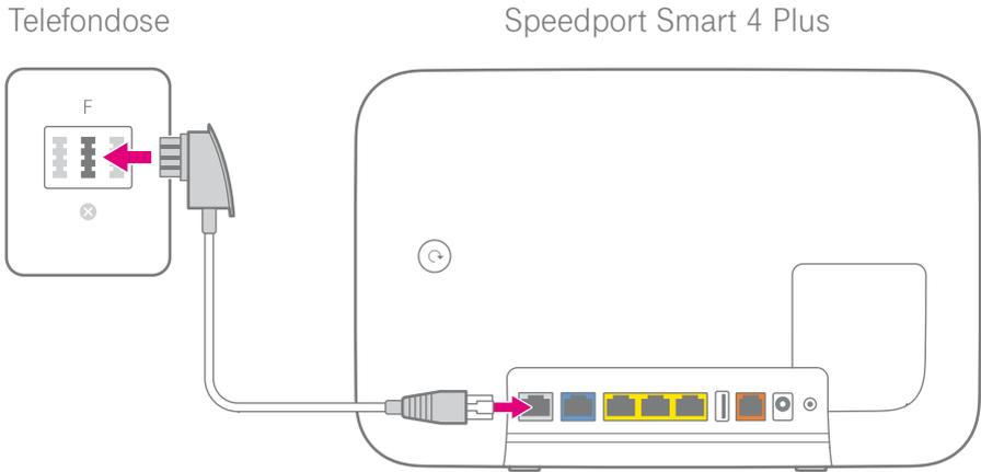
An einem DSL-Anschluss schließen Sie das DSL-Kabel (graue Stecker) an die in Ihrem Haushalt montierte Telefondose (mittlere Buchse) und die DSL-Buchse Ihres Speedport an.
