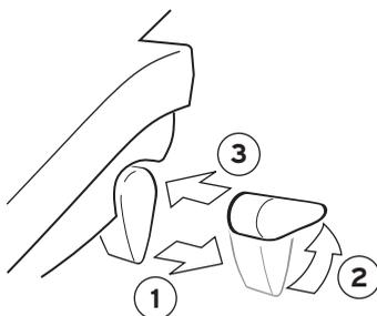
Ziehen Sie die Aufstellfüße heraus (1) und drehen Sie sie – zwei Stufen sind möglich – nach vorn oder hinten (2). Schieben Sie die Füße wieder ein (3).
