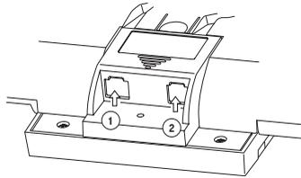
U<sub>pn</sub>-Adapter auf der Geräterückseite eines T-Comfort 730 Systemtelefons
