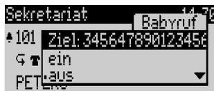
Sind Zifferneingaben länger als der Display-Bereich, werden diese nach links aus dem sichtbaren Bereich herausgeschoben.
