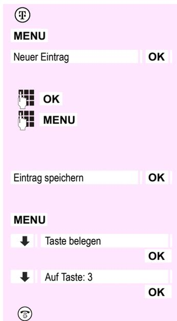
Das Bild zeigt ein Menü zur Konfiguration der T-Tasten. Es besteht aus mehreren Schritten:
