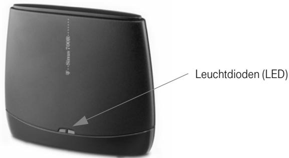
Die **linke LED** zeigt den **Anmeldezustand und die Betriebsbereitschaft** an, die **rechte LED** signalisiert die **Mobilteil-Verbindungen über den Repeater**.
